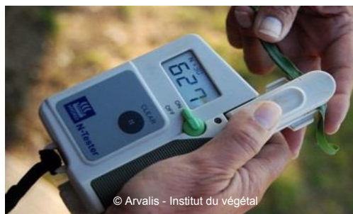
Photo 1. Boitier YARA-N-tester pour mesurer optiquement la teneur en chlorophylle des feuilles qui est fortement corrélée à l'état de nutrition de la plante (Yara, Arvalis- Institut du végétal).
