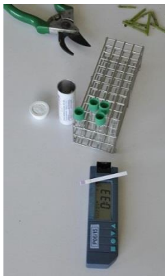
Photo 2. Matériel pour la mesure JUBIL® basée sur le dosage de la teneur en nitrate du jus de base de tige pour estimer le niveau d'alimentation de la plante (INRA, Arvalis- Institut du végétal).
