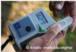
Boitier N-tester pour mesurer optiquement la teneur en chlorophylle des feuilles qui est fortement corrélée à l'état de nutrition de la plante (Yara, Arvalis- Institut du végétal).
