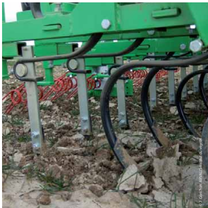
Sur cet essai, le binage est réalisé avec une bineuse Agronomic - Grégoire Agri de 3 m.
